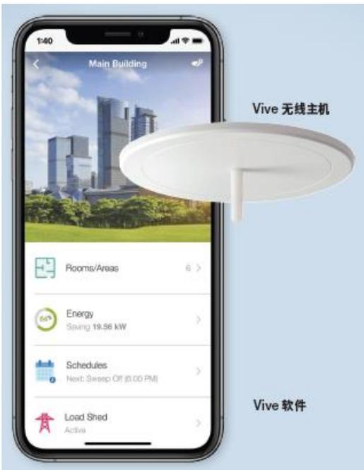
路創代理商的工程人員除提供上門現場系統調試服務外，由於VIVE系統極之簡單，設施管理人員只要接受半天的培訓，便能利用手機軟體自行更改系統設定（如調整自動控制時間表或燈光亮度等），甚至更換或增減燈控設備。
